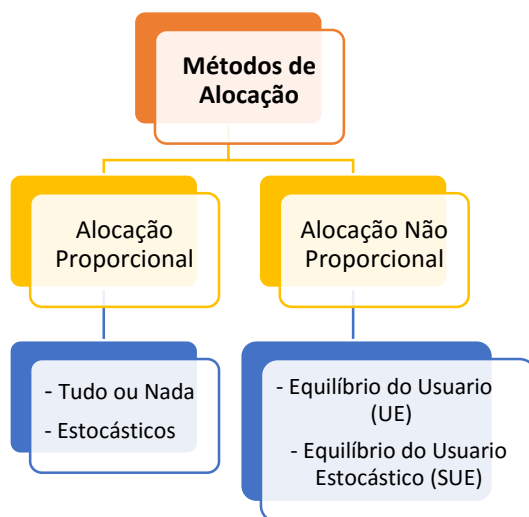
Figura 1 – Métodos de alocação de tráfego para estimação de matrizes O-D.
